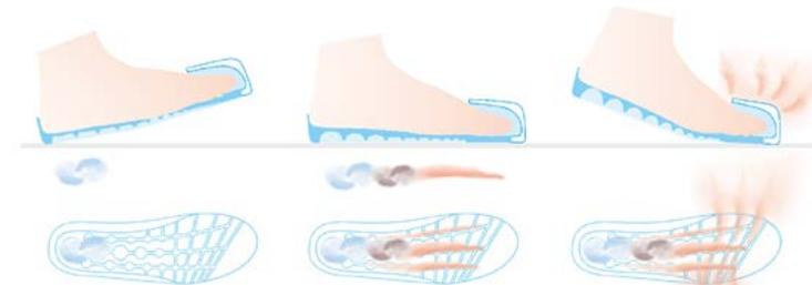
Der Druck der Ferse auf die Einlegesohle, durch den die Kuppeln zerdrückt werden, führt zu einer Luftverdrängung.
