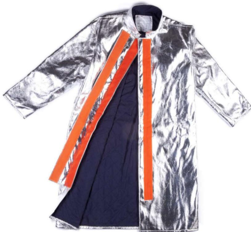
Cappotta realizzata in tessuto alluminizzato SAFAL GREEN da 340 gr. (50% para-aramidico 50% Panox), internamente coibentati con tessuto OXISTOP da 325 gr. composto da: feltro in fibra preossidata da 200 gr. trapuntato con fodera in tessuto 50% aramidico 50% viscosa FR da 125 gr. Apertura anteriore chiusa da bandella di protezione tramite Velcro® F.R. Chiusura interna tramite sotto finta fermata da Velcro® F.R. Collo alla coreana; maniche ad ampio giro.
