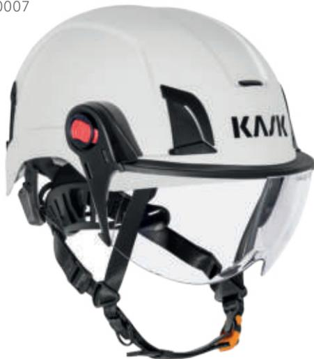
Protection des yeux en polycarbonate conçue pour une utilisation avec tous les casques de la série Zenith. Conforme à la norme EN 166 pour la protection des yeux des travailleurs avec impact à moyenne énergie. S'attache avec adaptateurs pour attache rapide de la visière. Se lève ou se rabat en toute sécurité. Verres disponibles en 3 couleurs pour différents niveaux de transmission de la lumière.
