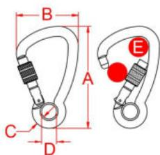
Moschettone ovale in acciaio al carbonio ad ampia apertura. Alto carico di 40 kN. Ideale per impieghi gravosi e per il collegamento ad ancoraggi strutturali, linee vita, ecc.
